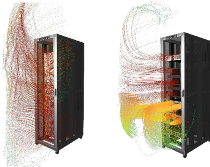
Abbildung 6: Abluftströmungsmuster auf Schrankebene für einen Konstruktionsschrank (rechts) mit derselben Ausrüstung und einer gleichmäßig verteilten Last und einen Betriebsschrank (links) mit unterschiedlichen IT- und Leistungsdichten
